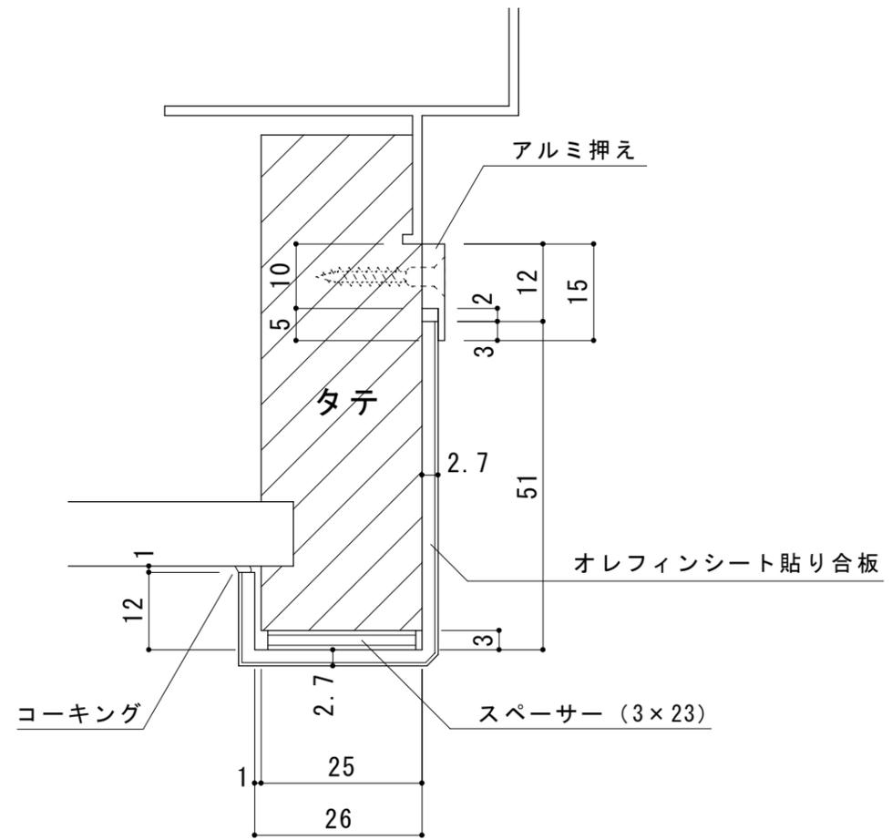
Re-mado Bタイプ チリ有(コ型)納まり図 例) タテ枠 25×60 ヨコ枠 25×60 の場合
